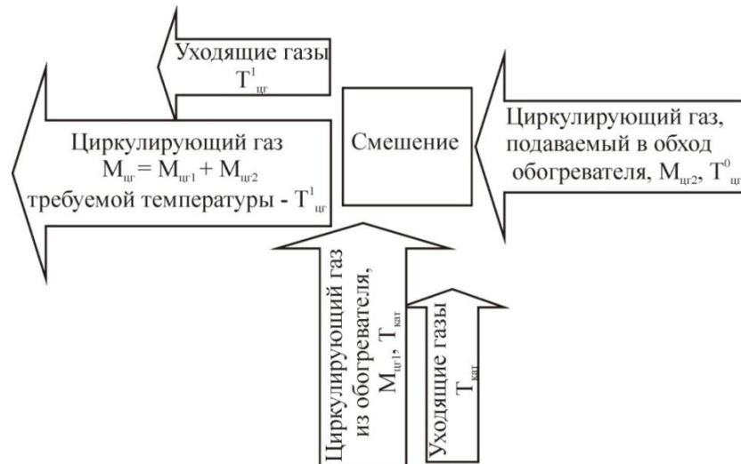
Рисунок 9 - Схема II смешения основной части циркулирующего газа и выходящих из обогревателя газов
