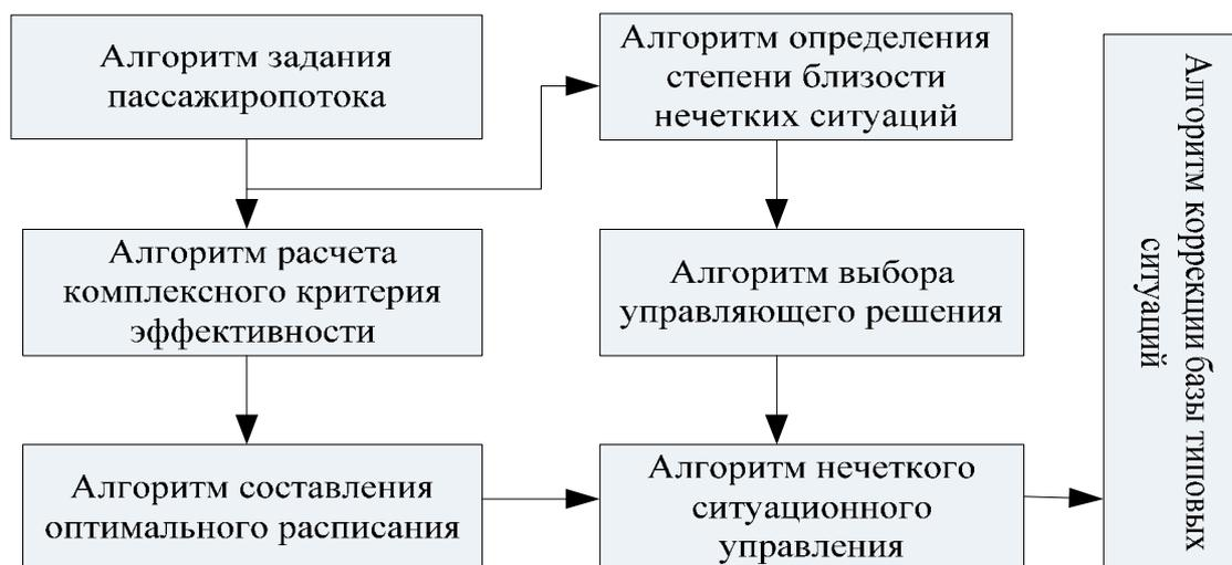
**Рисунок 3. Алгоритмическая структура интеллектуальной системы управления движением**
