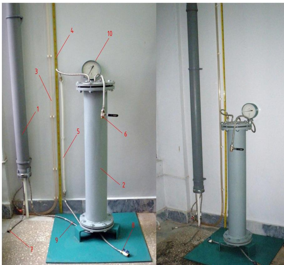
Рисунок 3. Фото экспериментальной установки по определению коэффициента сжатия
