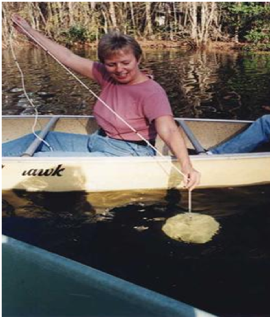
Рисунок 1 Измерение прозрачности диском Секки
