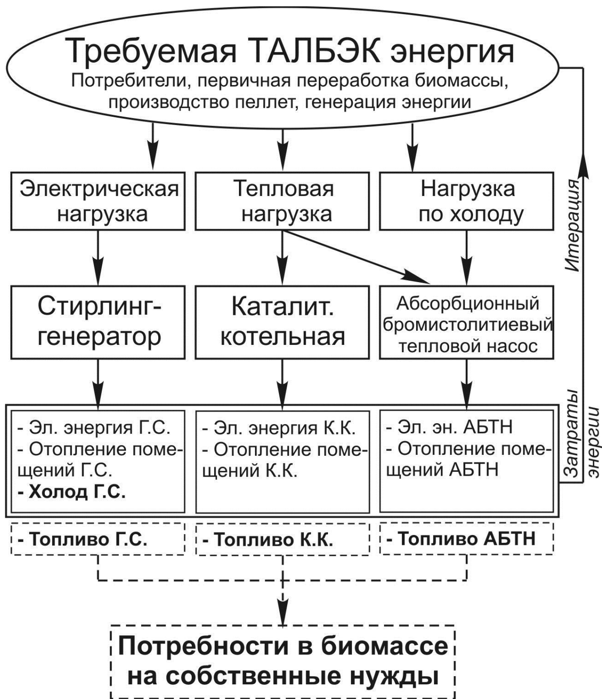
Рисунок 2 – Принцип моделирования процессов функционирования энергетической системы
