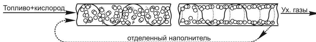
Рисунок 9 – Схема функционирования каталитической системы с перемещаемым каталитическим наполнителем с поперечным отделением от потока
