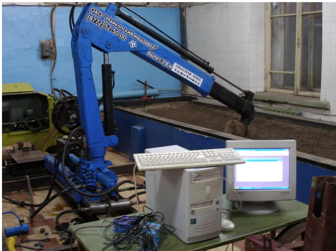
Рисунок 3 – Общий вид манипулятора ЛВ-210-01 с контрольно-измерительной аппаратурой и демпфером
