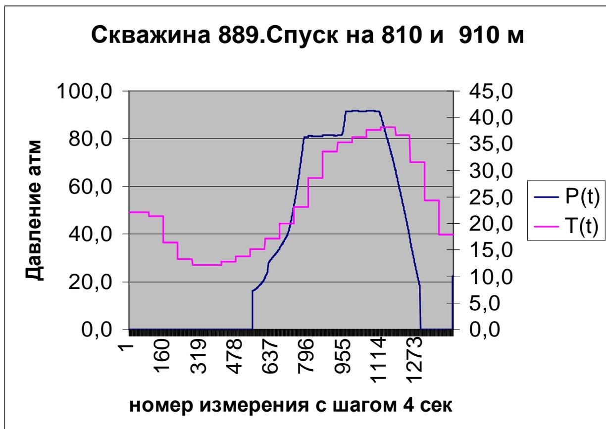
Рис. 3. Изменение давления и температуры в процессе спуска-подъема ВИД-1 в скважину
