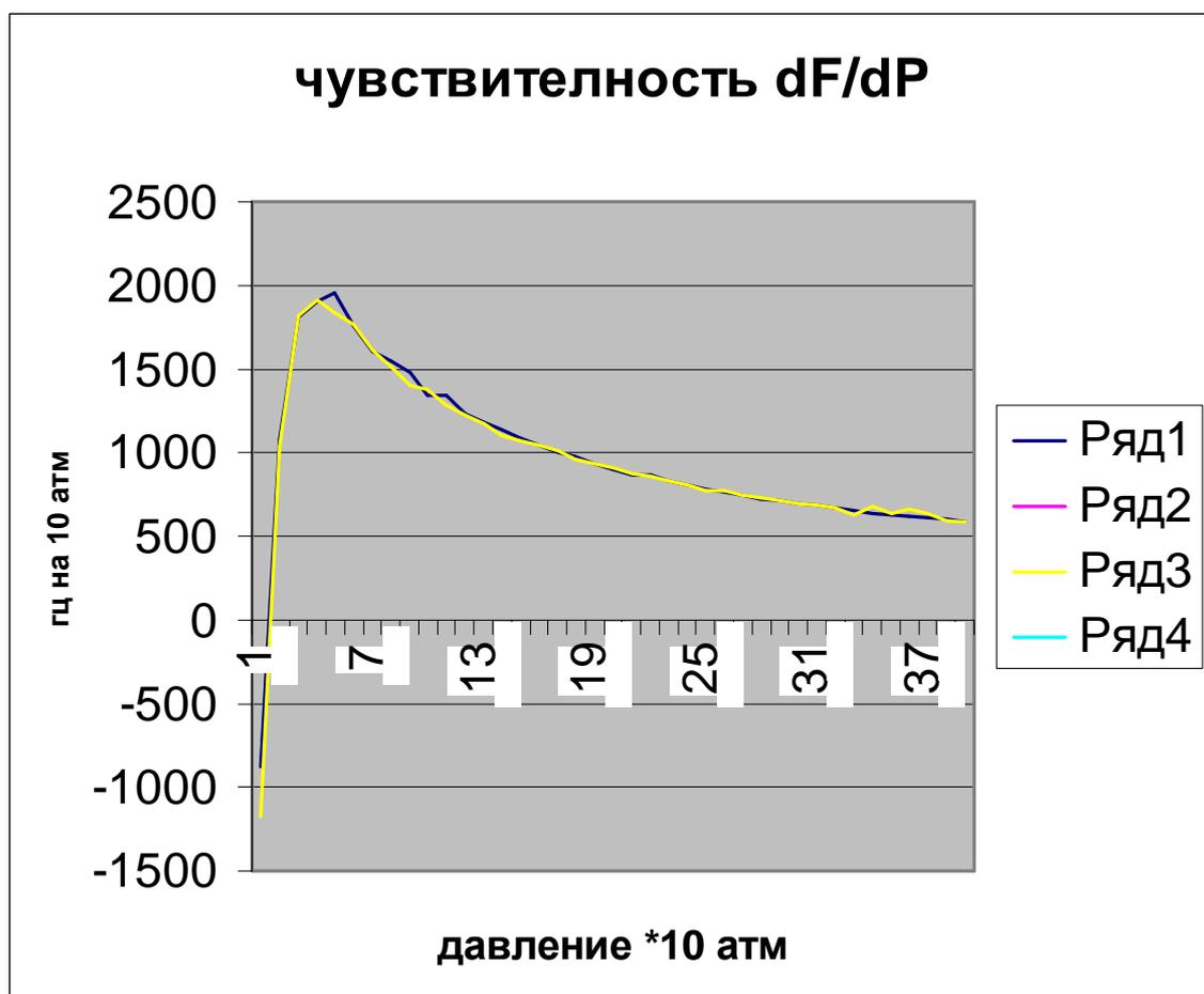
Рис. 2. Изменение чувствительности магнитоупругого датчика усилий при различных температурах (30 °С – ряд 1, 40 – ряд 2, 60 – ряд 3, 70 – ряд 4) и изменении давления тарировки от 0 до 400 атм.
