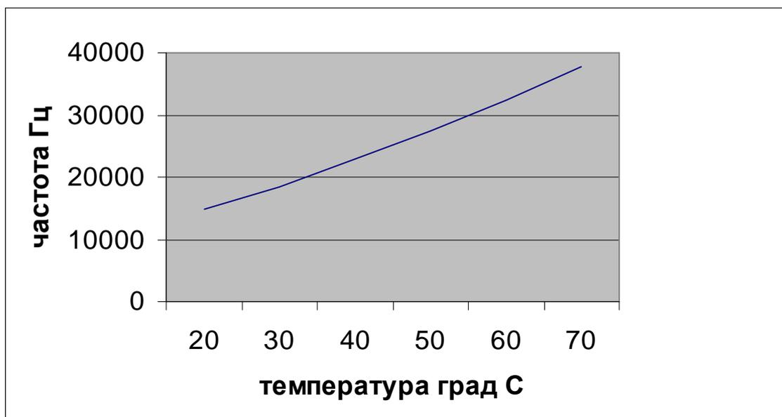
Рис. 1. Тарировочная характеристика датчика температуры
